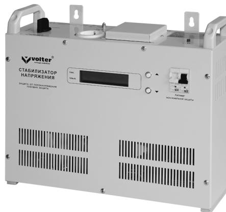
Стабилизаторы оснащены жидкокристаллическими индикаторами, кнопками управления и кронштейнами для крепления на стену. С помощью кнопок управления можно изменять среднее выходное напряжение стабилизатора в диапазоне 205-235 В с шагом 1 В.
