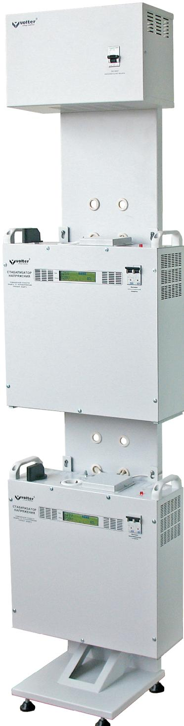
Стабилизаторы напряжения серии ПТТМ мощностью 18, 22 и 27 кВт конструктивно состоят из 2-х одинаковых стабилизаторов половинной мощности 9, 11, и 14 кВт соответственно. Стабилизаторы объединяются при помощи специальной стойки с общим автоматическим выключателем и работают параллельно на общую нагрузку. При этом все технические характеристики сохраняются.
